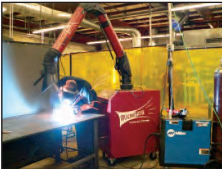
Colector Portátil TM1000 en Zona de Soldadura.
